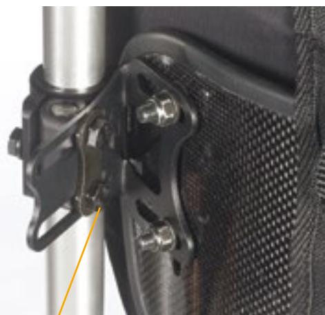
Das feste Halterungssystem ist die gewichtssparendste Lösung.
